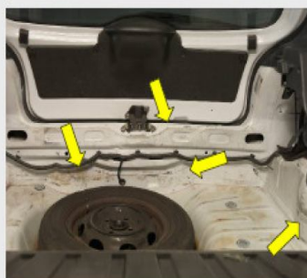
Riscos profundos que demandem reparo, amassados ou elevado número de riscos afetem o aspecto visual do compartimento de carga.
