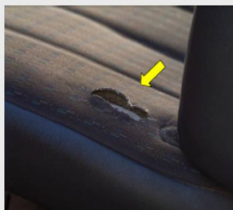
Bancos, consoles ou painéis furados, rasgados, queimados, ou com manchas que não possam ser removidas. Painéis furados para a colocação de alto falante, sem as devidas guarnições.
