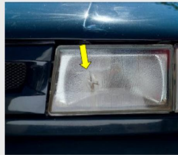
Faróis trincados ou quebrados
