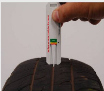
Pneus com desgaste regular que não tenham ainda atingido o momento de troca, ou seja, a profundidade dos sulcos da banda de rodagem superior a 1,6 mm. A indicação do momento de troca é verificada pelas marcações do TWI (Tread Wear Indicators).
