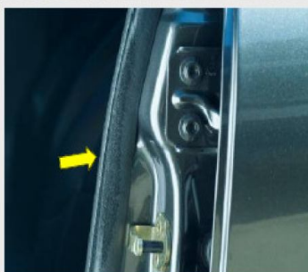
Desgaste natural das borrachas, tapetes, bancos, consoles e guarnições.
