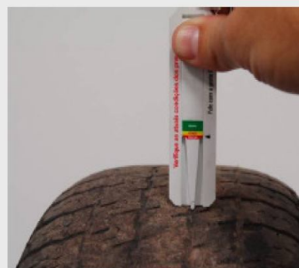
Pneus com desgaste regular que não tenham ainda atingido o momento de troca, ou seja, a profundidade dos sulcos da banda de rodagem superior a 1,6 mm. A indicação do momento de troca é verificada pelas marcações do TWI (Tread Wear Indicators).
