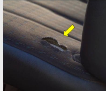
Bancos, consoles ou painéis furados, rasgados, queimados, ou com manchas que não possam ser removidas. Painéis furados para a colocação de alto falante, sem as devidas guarnições.
