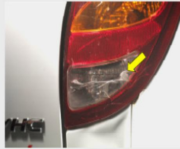
Lanterna trincada ou quebrada
