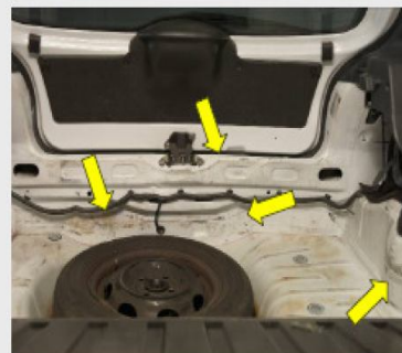
Riscos profundos que demandem reparo, amassados ou elevado número de riscos afetem o aspecto visual do compartimento de carga.
