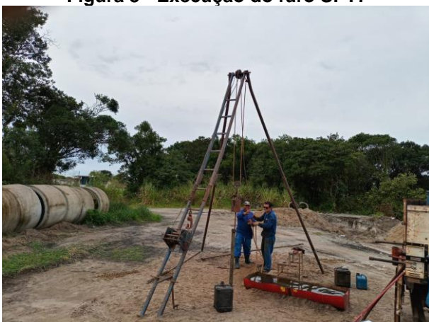
Figura 5 – Execução do furo SPT2
