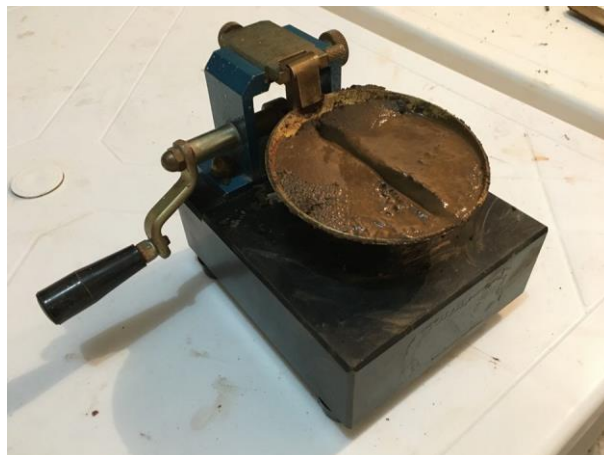
Figura 2 – Ensaio de Limite Liquidez
