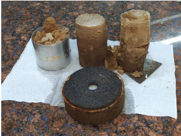
Figura 1 – Cilindros de solo extraídos após ensaio triaxial
