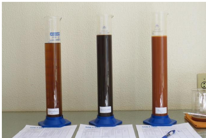
Figura 1 – Ensaio de sedimentação em andamento
