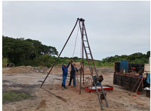
Figura 8 - Execução do furo SPT6
