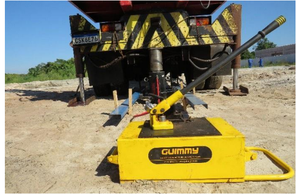
Figura 2 - Sistema de aplicação de carga
