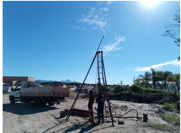
Figura 2 - Execução do furo SPT 5
