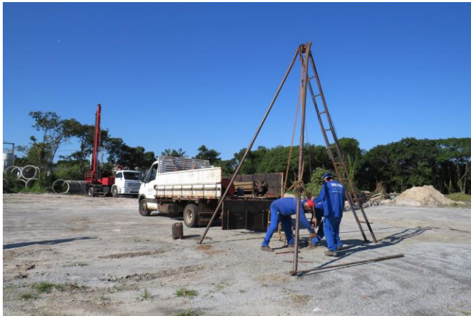
Figura 7 – Execução do furo SPT8
