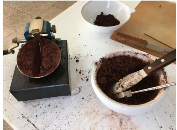
Figura 2 – Ensaio de Limite Liquidez e plasticidade em andamento
