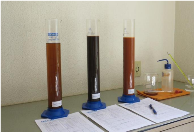
Figura 1 – Ensaio de sedimentação em andamento
