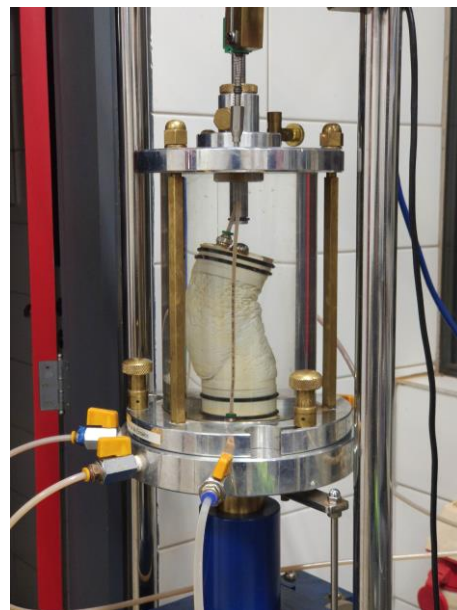
Figura 2 – Imagem de corpo de prova rompido sob cisalhamento
