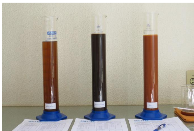
Figura 3 – Ensaio de sedimentação em andamento
