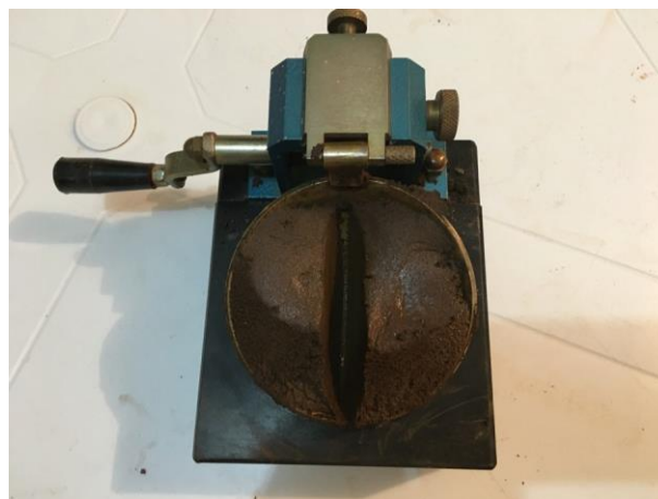
Figura 2 – Ensaio de Limite Liquidez em andamento
