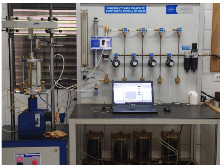
Figura 3 – Amostra indeformada sob ensaio e amostras pós ruptura
