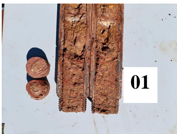
Figura 9 - Sonda com solo da Camada 3 (Furo 01)
