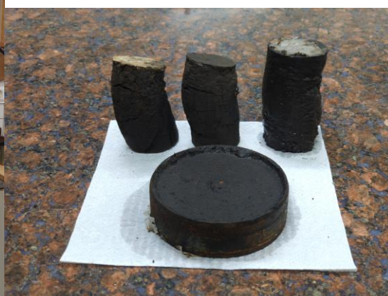
Figura 3 – Amostra indeformada sob ensaio e amostras pós ruptura
