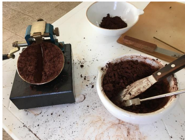
Figura 2 – Ensaio de Limite Liquidez em andamento
