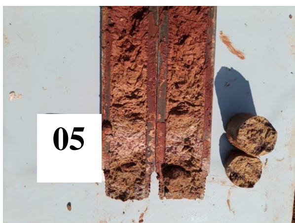
Figura 11 - Sonda com solo da Camada 2 (Furo 05)
