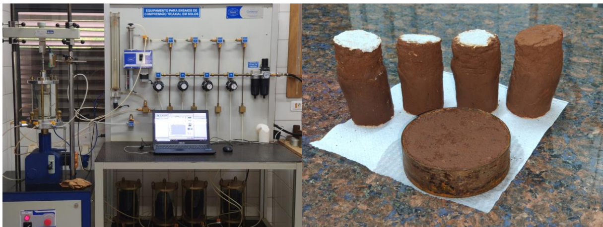
Figura 3 – Amostra indeformada sob ensaio e amostras pós ruptura
