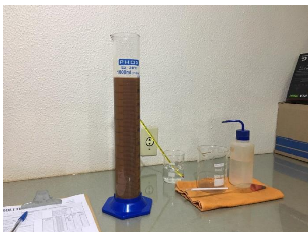
Figura 3 – Ensaio de sedimentação em andamento
